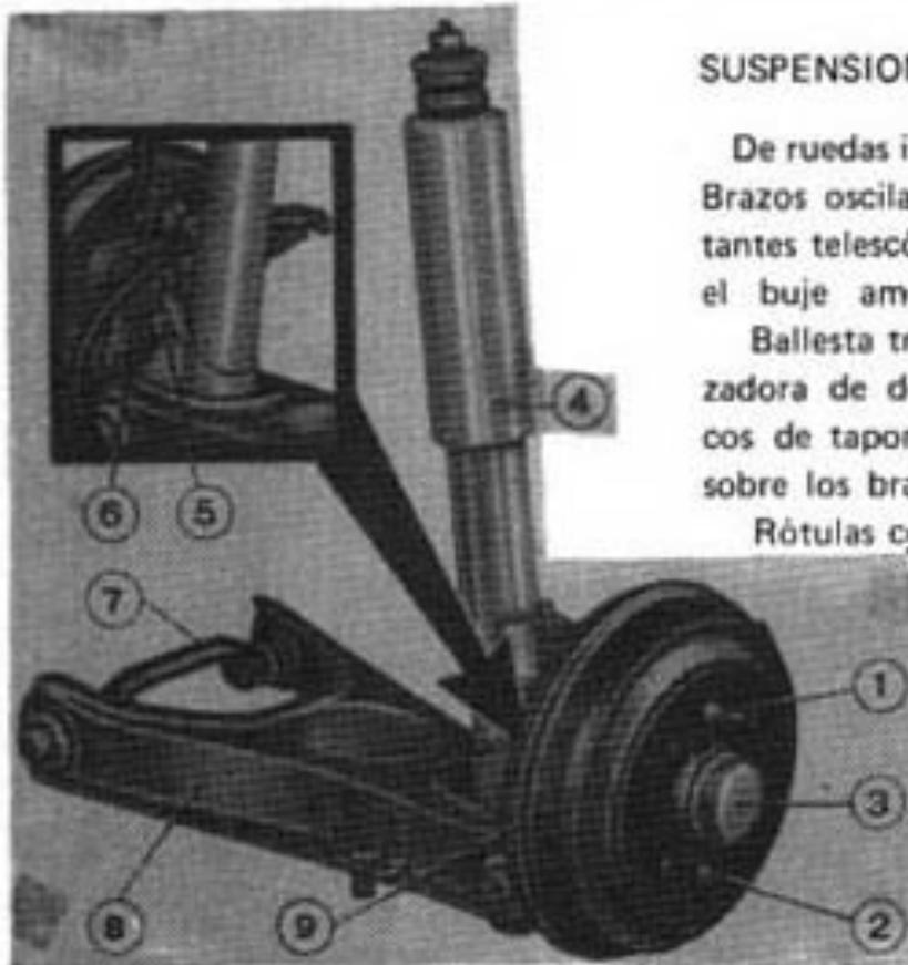
1.- Pivote centrado rueda y fijación tambor al buje. 2.- Tornillo fijación tambor al buje. 3.- Cazoleta para cubo buje. 4.- Amortiguador hidráulico. 5.- Tornillo fijación amortiguador a la mangueta. 6.- Eje portarrueda. 7.- Perno unión brazo oscilante a la carrocería. 8.- Brazo oscilante. 9.- Tambor frenos.
